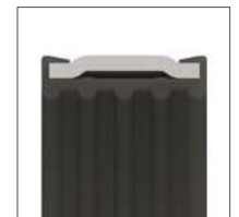
Валикообразный профиль изолирующей вставки
