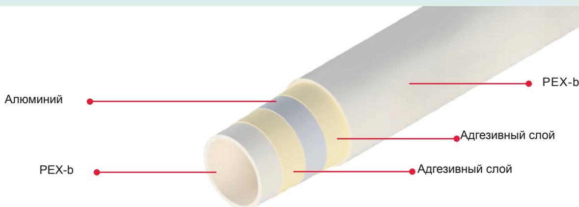
**МНОГОСЛОЙНЫЕ ТРУБЫ AIS PEXb-AI-PEXb:** легче металлических труб, номинальный диаметр от 16 до 32 мм., номинальное давление 10 бар/95°C
