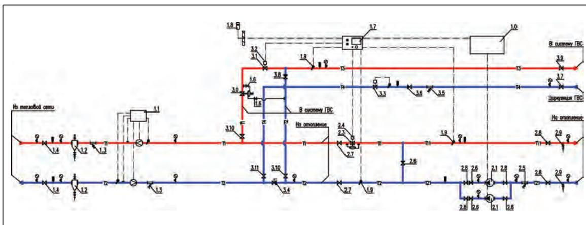
1.2. Блочный тепловой пункт с зависимой системой отопления и закрытой 2-ступенчатой системой ГВС для г. Нур-Султан
