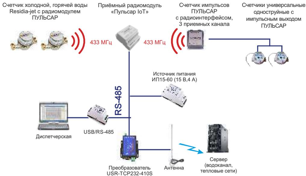
Счетчики воды и тепла, оборудование для дистанционного съема показаний
