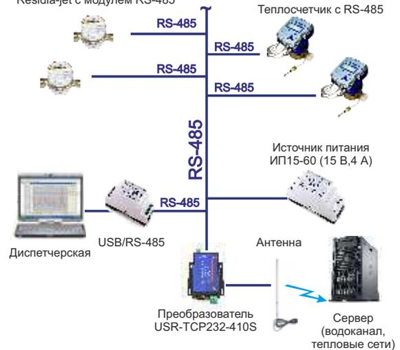
Счетчики воды и тепла
